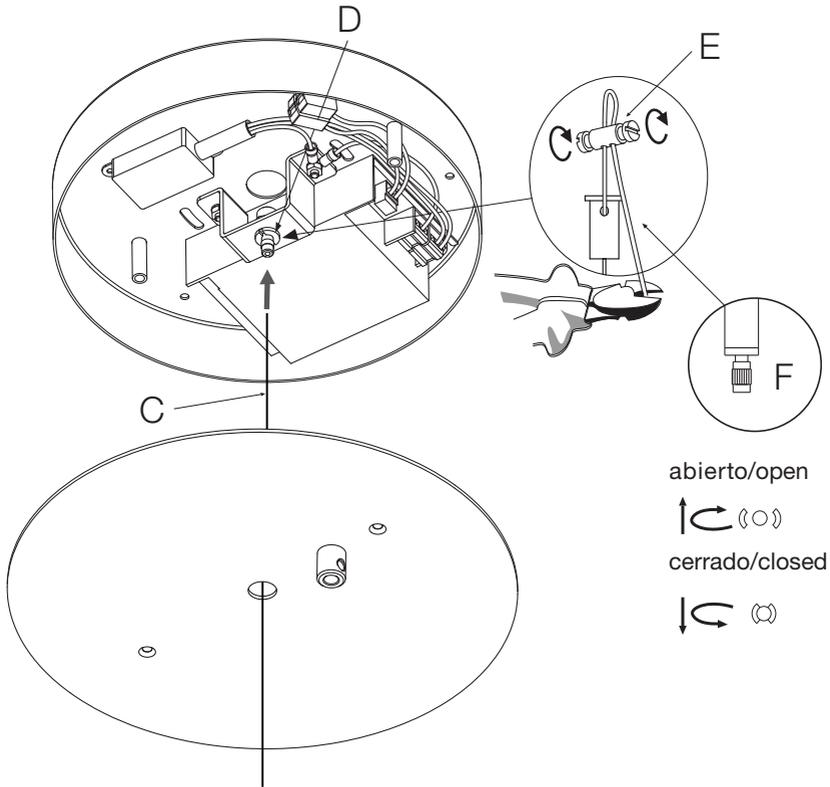
3.1. Coger la lámpara y pasar el cable de acero (C) a través de la tapa. Introducir en el suspensor (D).
