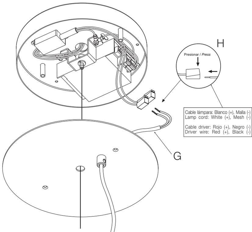
4.1. Pasar el cable eléctrico a través del prensacables (G) del florón. Hacer la conexión eléctrica en los conectores (H).
