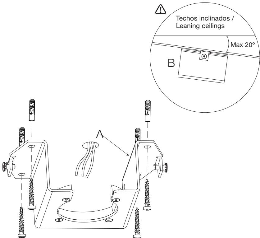
1.1. Coger la pieza (A) y fijarla en el techo utilizando los tronillos y tacos suministrados.
