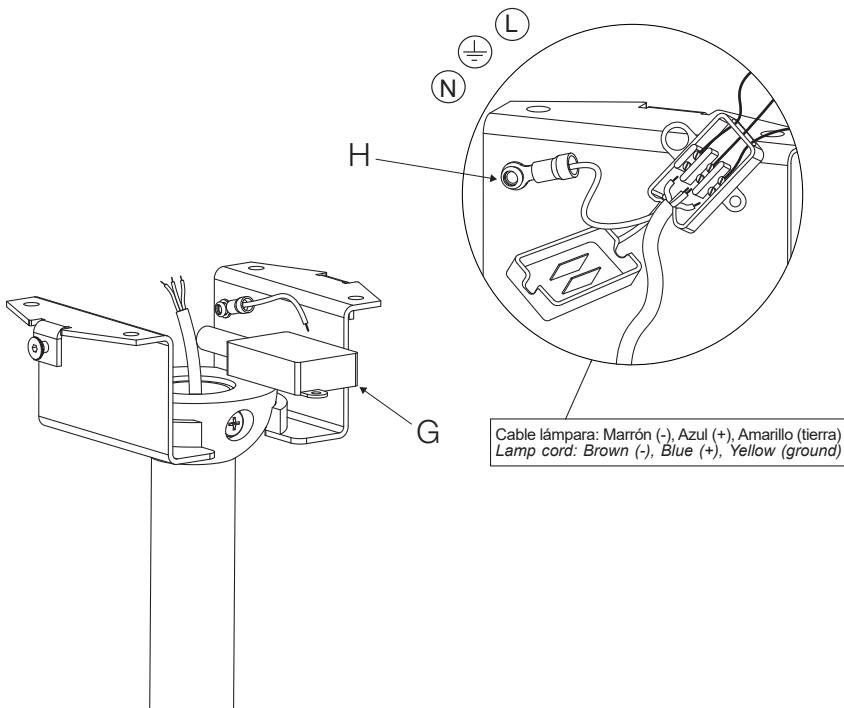
4.1. Pelear los cables y realizar las conexiones de red en la caja de empalmes (G).
