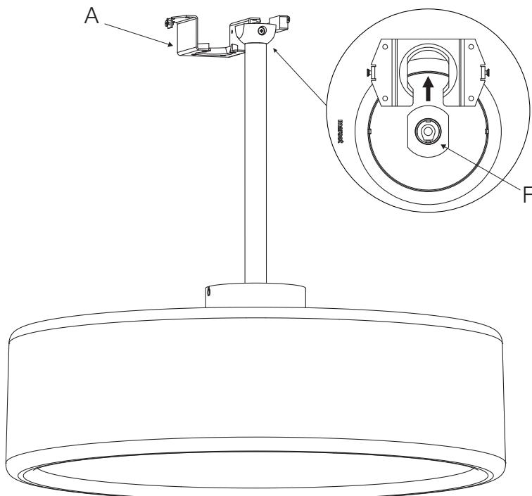
3.1. Coger la lámpara y colocarla dentro de la estructura (A).
