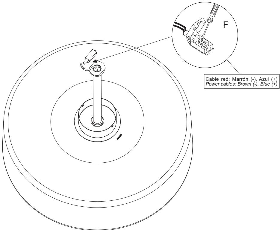
3. Coger la regleta (F) y hacer la conexión eléctrica con los cables de la lámpara.
