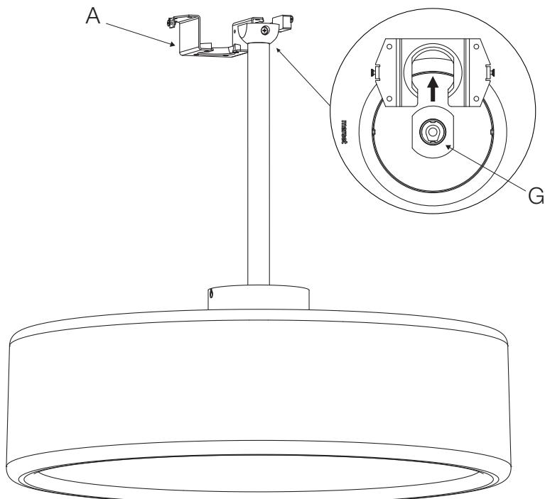
4.1. Coger la lámpara y colocarla dentro de la estructura (A).
