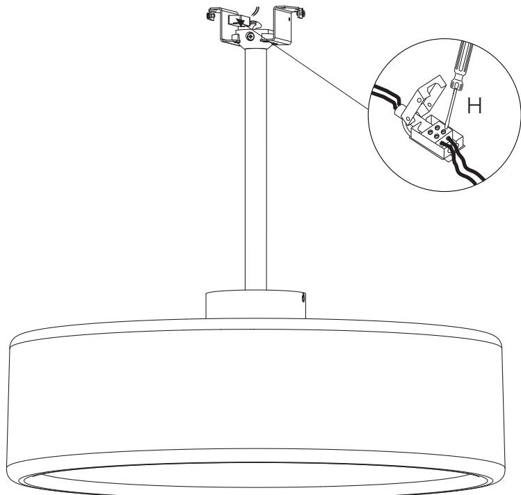
5. Pelar los cables y realizar las conexiones de red en la caja de empalmes (H).
