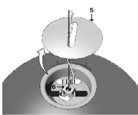
Per bilanciare la lampada, sollevare la copertura (5), allentare il dispositivo (6) e regolarlo spostandolo avanti e indietro fino a trovare la posizione corretta. Quindi riposizionare la copertura (5).
