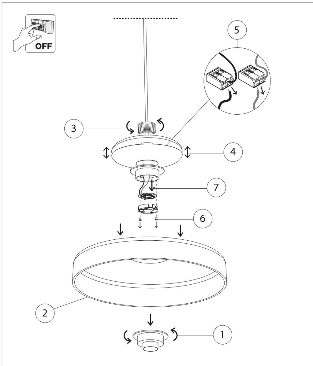
Segui le istruzioni di montaggio a ritroso per avere più chiare le operazioni di smontaggio
