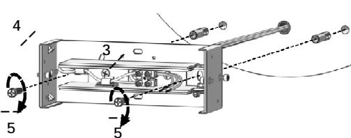
Eseguire i fori a parete. Far passare i cavi di alimentazione attraverso il foro (3) presente sulla parte centrale del fondello (4). Fissare il fondello a parete mediante le viti (5).
