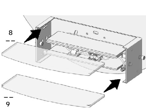
Posizionare i vetri (8) e (9) infilandoli sul fondello (4) attraverso le apposite guide. Rimontare la fascia (2).
