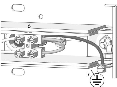
Effettuare i collegamenti elettrici al morsetto (6). Collegare il cavo di messa a terra all'apposita vite (7) come indicato in figura.
