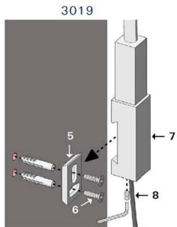
Per il modello a parete, praticare i fori e fissare la piastra (5) a parete tramite le due viti (6). Quindi montare il supporto (7) sulla piastra e fissarlo tramite la vite con chiave a brugola (8).
