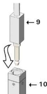
Per tutti e tre i modelli, occorre effettuare il collegamento elettrico tramite jack, inserendo il corpo lampada (9) nella relativa presa (10).
