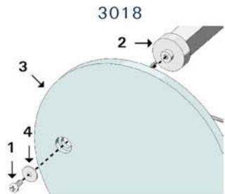
Per il modello a terra, dopo aver svitato la vite (1) dallo stelo (2), montare la base (3) e fissarla allo stelo (2) tramite la vite (1) e l'apposita guarnizione (4).
