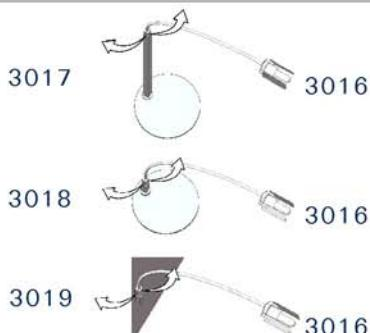
Orientare la fonte luminosa ruotando il corpo lampada (3016) fino alla posizione desiderata. I modelli 3017 e 3018 possono ruotare di 360°.
