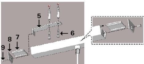
Fissare le due staffe (5) al soffitto mediante le viti (6). Avvicinare il binario alle staffe (5) e agganciarlo attraverso le apposite piastre (7). Bloccare le staffe al binario attraverso gli appositi tappi di chiusura (8), fissandoli tramite le viti (9).
