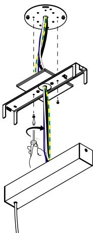
**10** If the cable length is already the desired one, go directly to point 13, otherwise unscrew the bushing and slip off the 2 cables / Si la longueur du câble est déjà celle souhaitée, allez directement au point 13, sinon dévissez la bague et glissez les 2 câbles
