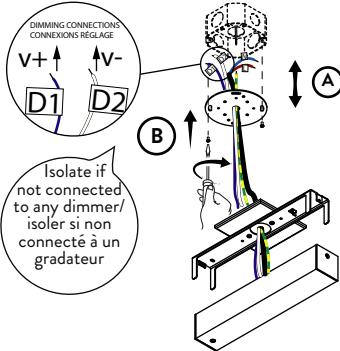
**9 Connect the bracket to the J-box / Connectez le support à la J-box**
