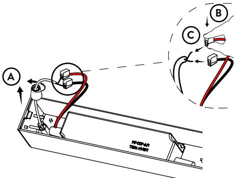
**11 Adjust the cable and cut it following the scheme, then close the bushing / Ajustez le câble et coupez-le selon le schéma, puis fermez la bague**
