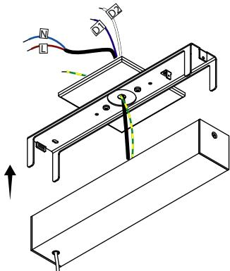
**8 Connect the cables and fix the crossbar to the J-box / Connectez les câbles et fixez la barre à la J-box**
