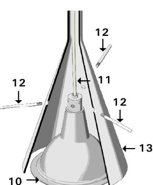
Montare il riflettore (10) sullo stelo (11) e, per fissarlo all'apparecchio, inserire i tre distanziatori (12) nei fori che si trovano sul diffusore (13) e avvitarli nei fori del riflettore.
