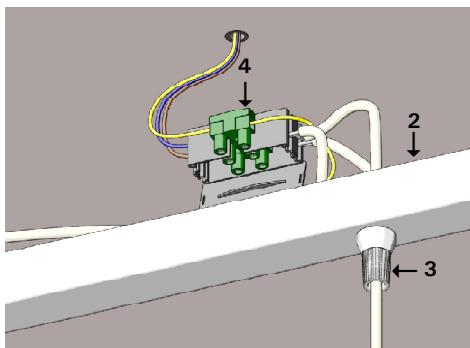
Avvicinare il binario (2) al soffitto, svitare il bloccacavo (3), regolare la lunghezza del cavo e serrare. Effettuare i collegamenti elettrici all'apposito morsetto (4), facendo attenzione a collocare il cavo di messa a terra in prossimità del simbolo .
