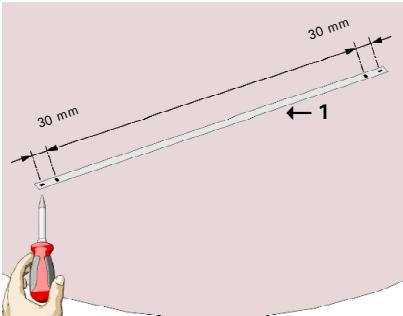
Utilizzare la dima (1) per segnare i fori a soffitto (la distanza tra i fori delle staffe è di 630 mm per il modello 3337/2 e di 1130 mm per il modello 3337/3).
