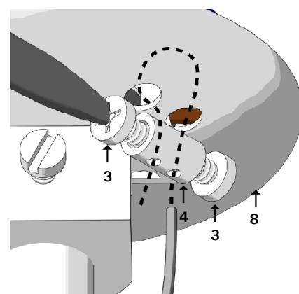
Infilare l'estremità opposta dei cavi di sospensione in uno dei due fori del morsetto (4), farla passare nei due fori presenti sul supporto (8) e, infine, nel secondo foro del morsetto (4). Stabilire la distanza tra il diffusore (5) e il soffitto, regolare di conseguenza la lunghezza dei cavi di sospensione e stringere le viti (3) del morsetto (4).
