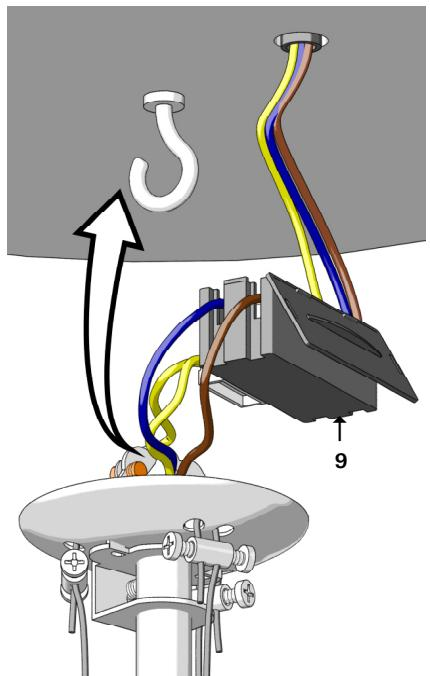
Aggiungere la lampada al soffitto, aprire la scatola contenente il morsetto (9) ed effettuare i collegamenti elettrici rispettando le posizioni dei cavi. Una volta completati i collegamenti, richiudere la scatola contenente il morsetto (9).
