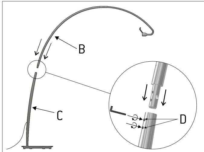
3- Encajar el brazo en la base. Fijar el brazo con el tornillo lateral (A) usando la llave allen suministrada. Figura 3
