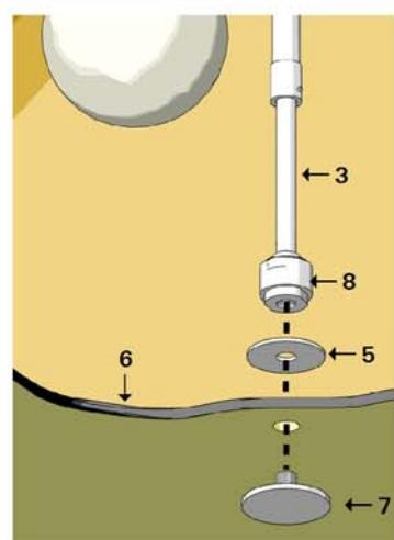
Posizionare la rondella (5) all'estremità inferiore della tige (3). Montare, quindi, il disco di chiusura (6) e fissarlo alla tige tramite la vite (7).
