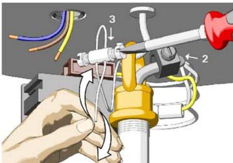
Avvicinare la lampada al soffitto e determinare l'altezza desiderata, posizionando i morsetti fermacavo (2) e (3) in funzione della lunghezza scelta.
