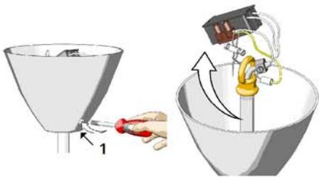
Utilizzando un cacciavite a taglio, svitare il grano (1) e far scorrere il rosone lungo i cavi. Unscrew dowel (1) by means of a cross-head screwdriver and let the rosette run along the cables.
